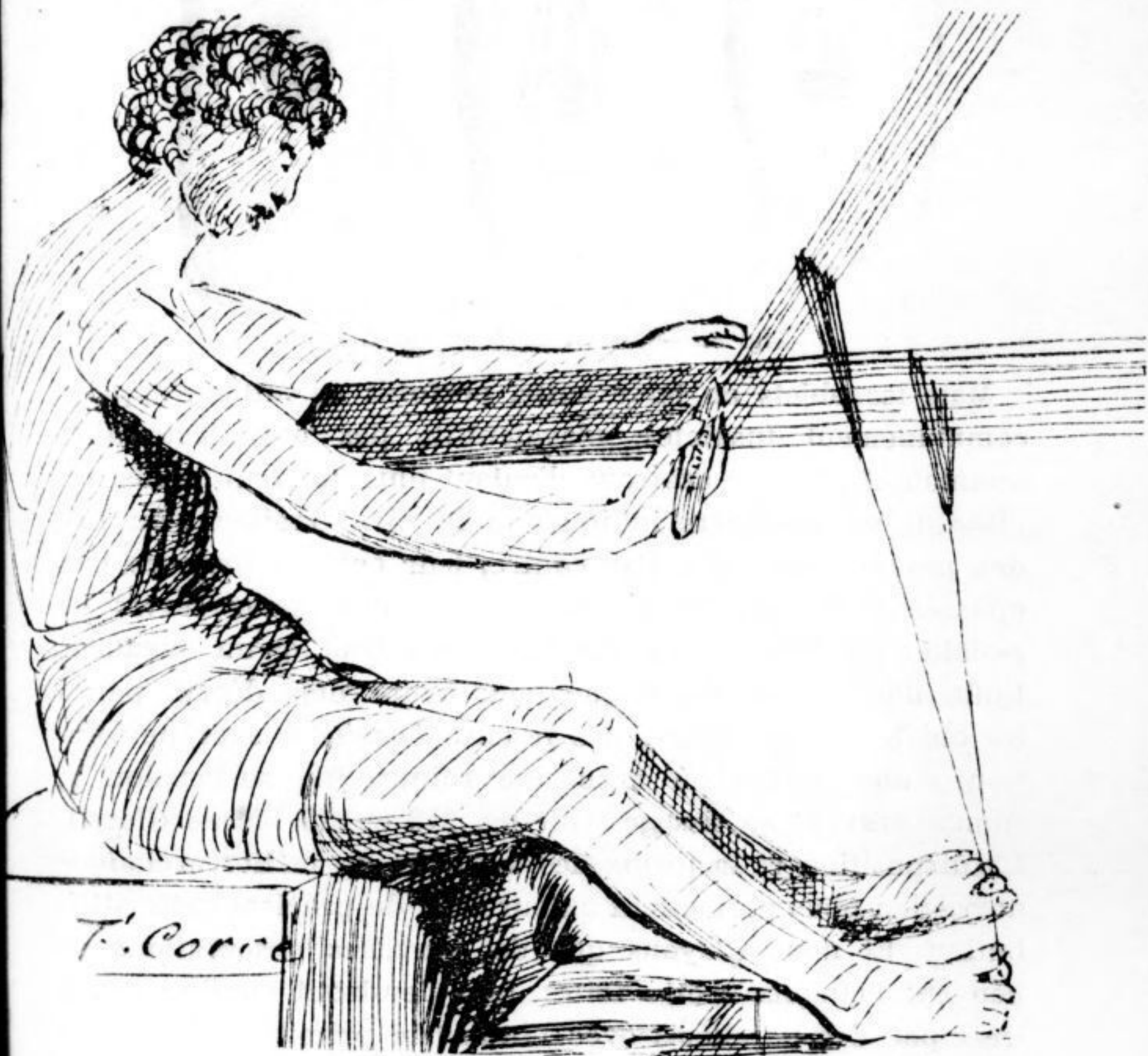
Fig. 4. — Galets perforés, placés entre le gros et le second orteil, servant de « tirants ».
